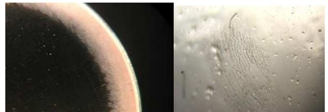
links Proteinablagerung auf einer formstabilen-, rechts auf einer weichen Contactlinse
